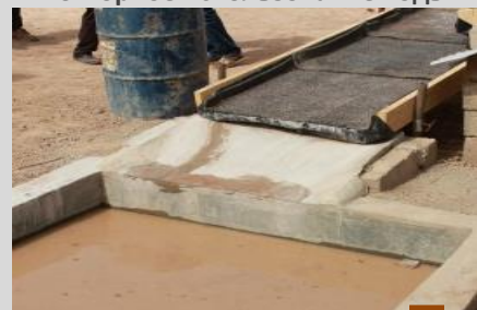
Безртутный пруд для хвостов и повторное использование воды
