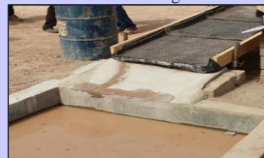
Balsa para relaves libre de mercurio y reciclado del agua
