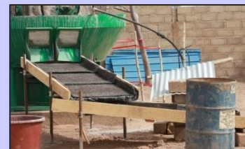
Criba de molino triturador en húmedo y esclusas, a continuación tapiz de lavado y batea
